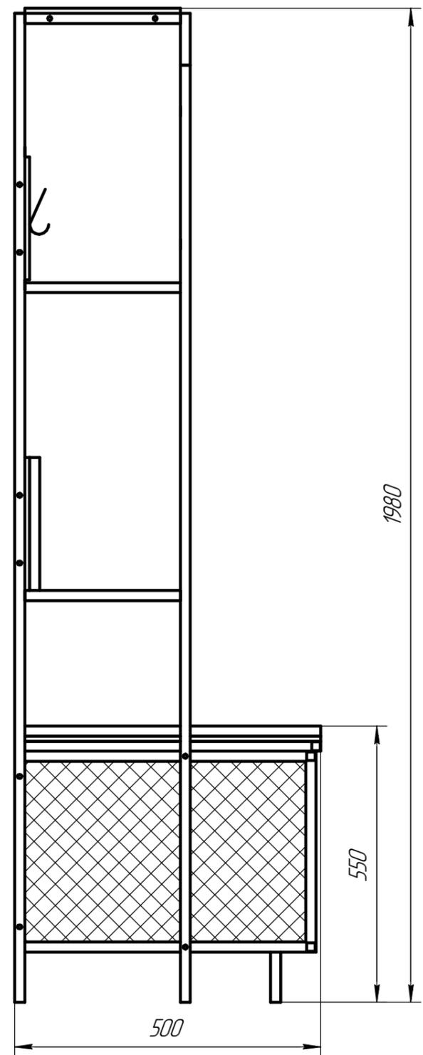
1. Материал каркаса - металлическая профильная труба;
